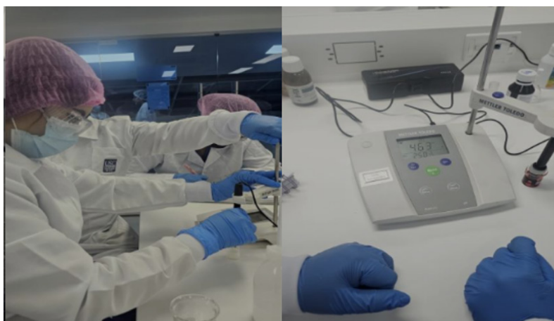
Figura 5. Proceso de limpieza del potenciómetro
