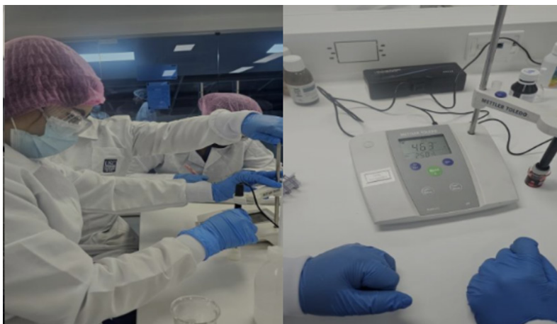
Figura 5. Proceso de limpieza del potenciómetro
