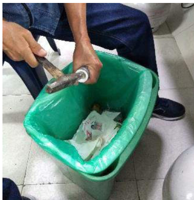
Ilustración 167. Liberación del colado de dentro del anillo.
