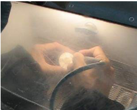
Ilustración 186. Arenado del anillo.
