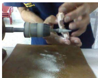
Ilustración 155. Pulido de los bordes de modelo con torno y pimpollo.
