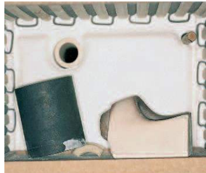
Ilustración 165. Ubicación del anillo dentro del horno, para el proceso de desencerado.
