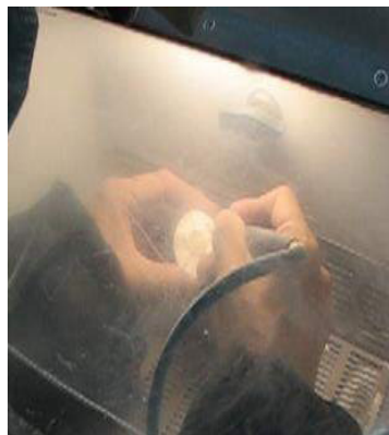
Ilustración 168. Limpieza del colado de los excesos de revestimiento, arenado con micropartículas de óxido de aluminio 50 micras.
