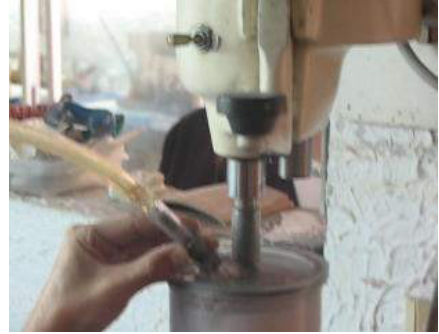
Ilustración 163. Mezcladora de vacío.
