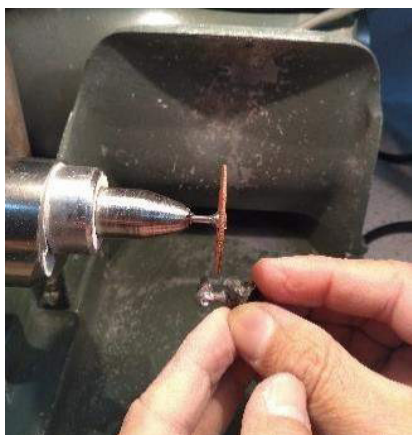
Ilustración 169. Corte del bebedero.
