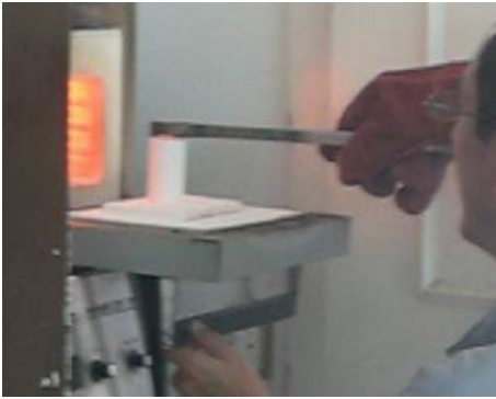
Ilustración 179. Ubicación del anillo en el horno de desencerar.
