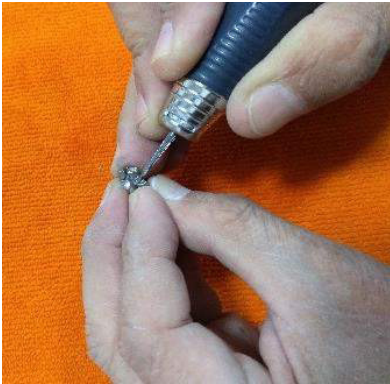
Ilustración 171. Pulido y brillo de la incrustación.
