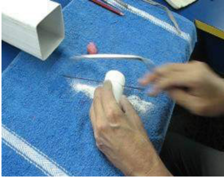
Ilustración 184. Segueteada del anillo.
