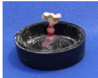
Ilustración 160. Posicionamiento del encerado sobre la peana.
